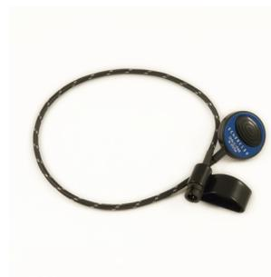
Microfono a contatto elettrodinamico attivo per violoncello, bilanciato con elettronica in classe A - Utilizzabile per tutti gli strumenti acustici e capace di riprodurre fedelmente il loro suono - Impedenza uscita: 4,7 KOhm a 1Khz - Gamma Freq.: 20-20000 Hz - Elettronica: Classe A - Connettore: XLR mp - Adatto a situazioni live e recording - Pasta modellabile e custodia incluse
