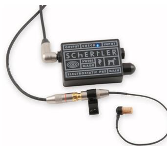
PickUp elettrostatico per Violoncello al ponte adatto a situazioni professionali e con alta resistenza al feedback - Elettrostatico - 20-12000 Hz - Sens. ca.: -25dB - Range dinamico: 75 dB - Alimentazione Phantom 10V -Lunghezza cavo 190 Cm - Uscita RCA - Preamplificatore STAT-PRE alimentato con batteria AA incluso - Custodia imbottita inclusa
