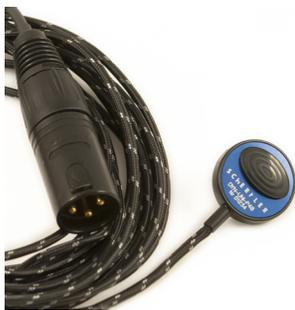
Microfono a contatto elettrodinamico attivo, bilanciato con elettronica in classe A - Utilizzabile per tutti gli strumenti acustici e capace di riprodurre fedelmente il loro suono - Impedenza uscita: 4,7 KOhm a 1Khz - Gamma Freq.: 20-20000 Hz - Elettronica: Classe A - Lunghezza Cavo: 4Mt - Connettore: XLR m - Adatto a situazioni live e recording - Pasta modellabile e custodia incluse
