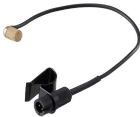
PickUp elettrostatico per Violino al ponte adatto a situazioni professionali e con alta resistenza al feedback - Elettrostatico - 20-12000 Hz - Sens. ca.: -25dB - Range dinamico: 75 dB - Alimentazione Phantom 10V - Uscita RCA
