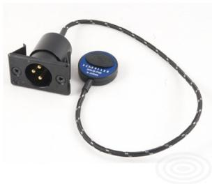
Microfono a contatto elettrodinamico attivo per contrabbasso, bilanciato con elettronica in classe A - Utilizzabile per tutti gli strumenti acustici e capace di riprodurre fedelmente il loro suono - Impedenza uscita: 4,7 KOhm a 1Khz - Gamma Freq.: 20-20000 Hz - Elettronica: Classe A - Connettore: XLR mp - Adatto a situazioni live e recording - Pasta modellabile e custodia incluse
