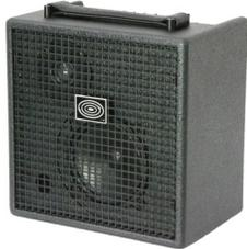
Combo per Chitarra Acustica - 50W RMS - Woofer 5" - Dome Tweeter 1" - 2 vie bass reflex - Crossover elettronico - 2 ingressi: Mic e Line con gain indipendenti - Controlli (line in): EQ 3 bande, Warm (passabasso), riverbero, Master Volume - Insert - Uscite: Line out e uscita DI Bilanciata a XLR -15dB - Alimentazione Phantom 24V per XLR e +10V per i microfoni piezo (Jack) - Cassa in multistrato - misure: H 28 cm - L 27 cm - P 18 cm - peso 6,8kg - Finitura Antracite antigraffio e griglia metallica
